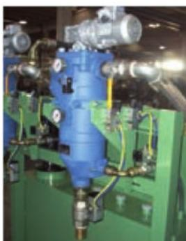
**Kazetová filtracia** - sa vykonáva cez kazetový filter, ktorý slúži na sanie aj výtlak kvapaliny. Filter je možné použiť samostatne, alebo v páre. Stupeň filtrovania sa pohybuje od 90 do 10 mikrónov.
