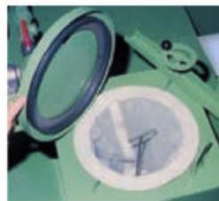
**Samočistiaci filter** - čistí chladiacu kvapalinu niekoľkými spôsobmi pomocou samočistiacej kazety. Odpad sa zbiera do zásobníkov bez potreby ďalšej údržby. Rozsah filtrovania je od 30 do 100 mikrónov.
