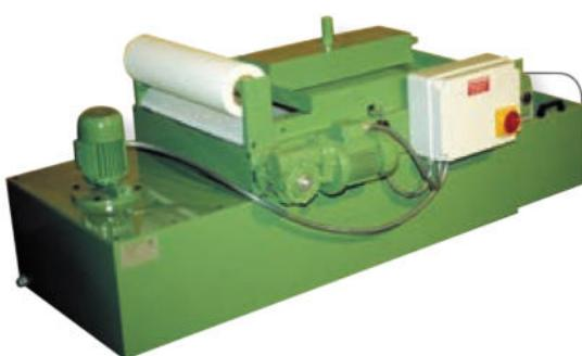
**Magnetický filter** - oddeluje železné časticie od chladiacej kvapaliny pomocou rotačného magnetického väčca. Filtrovanie sa uskutočňuje pri približne 100 mikrónoch a je možné ho spojiť s papierovým filtrom pre dôkladnejšiu filtrejciu.
